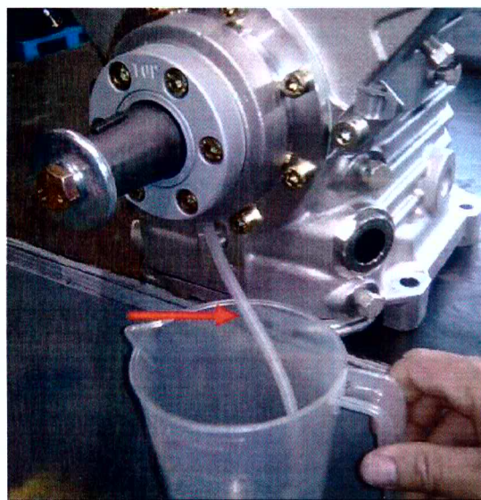
Posição para drenagem do óleo/Posición para agotar el aceite
