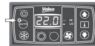
Válvulas de recirculação de ar abertas.
