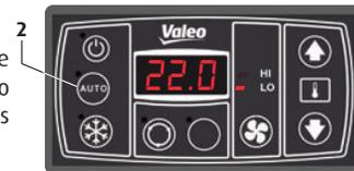
**Nota:** ao ativar o modo Auto, o sistema controla automaticamente os ventiladores do evaporador. Ao pressionar novamente o botão Auto, o controle automático dos ventiladores do evaporador é desligado.
