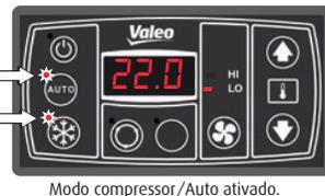
**Nota:** o compressor de ar condicionado deve ser desativado pelo menos 1 minuto antes de poder ser ligado novamente. Se o botão AC for pressionado durante este tempo, o dispositivo reativa o compressor de ar condicionado após 1 minuto (o botão AC pisca). O compressor de ar condicionado funciona por pelo menos 1 minuto antes de desligar. Se for desativado diretamente após a ativação, ele continuará a funcionar por 1 minuto (o botão AC pisca).
