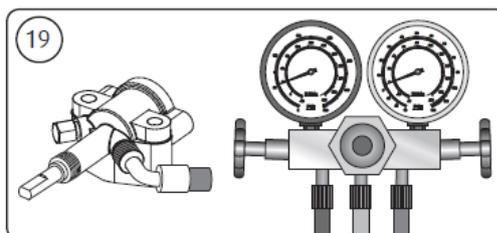
20- Verificar as pressões de abertura e fechamento dos pressostatos de alta e baixa.
