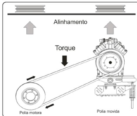
Inspeccionar periodicamente o conjunto de acionamento do compressor e alternador, tencionando corretamente as correias quando necessário.
